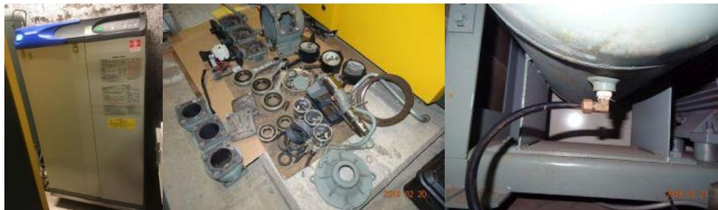
図2 (左) ベビコン。(中央) ベビコンの分解点検。(右) 錆が詰まっていた配管。
