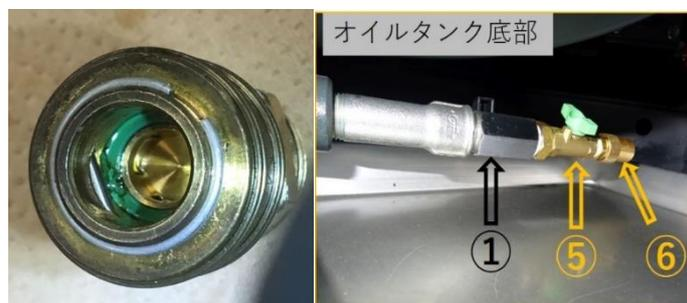
図9 (左) カプラ②(メス)内部。緑のパッキンが破損している。(右) オイルタンク底部。①ボールバルブ、⑤新しいボールバルブ、⑥新しいカプラ(メス)。オイルを追加するときは、新しいカプラ(オス)を使ってホースとつなぐ。
