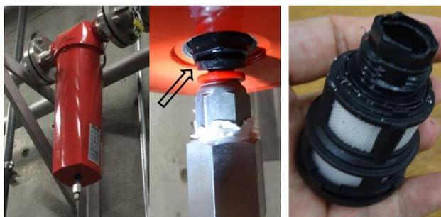
図10 (左) オイルフィルタ、(中央) オイルフィルタ底部、プラスチック部が割れている、(右) 中に入っていたドレントラップ。
