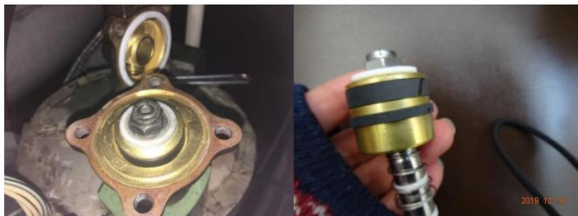
図 23 (左) 電磁バルブの分解。(右) 交換部品
